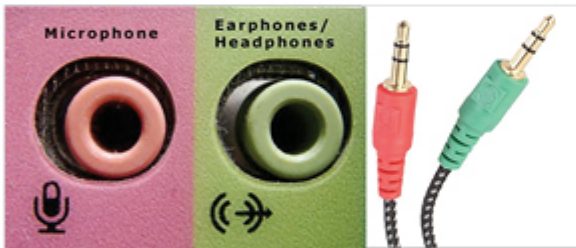
그림 2. 데스크톱 마이크 및 이어폰 입력 단자. 각각의 단자에 2개의 검은 선이 있다 (TRS).
